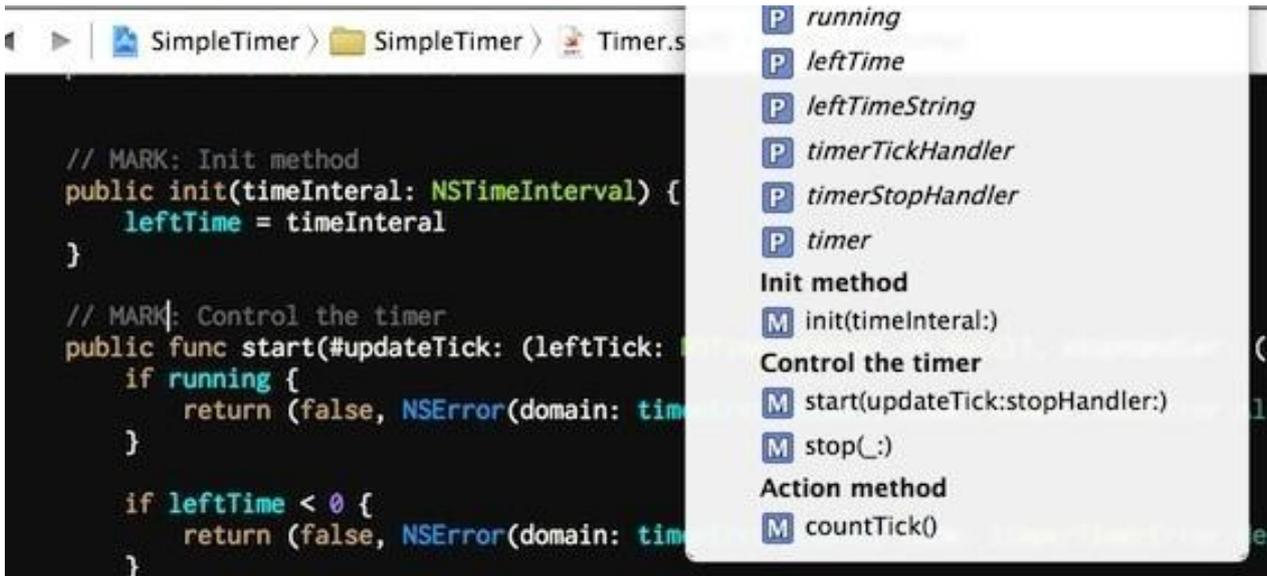
另外我们还可以在冒号的后面加一个横杠 `-`，这样在导航中会在这个位置再多显示一条横线，隔开各个部分，会显得更加清晰。
