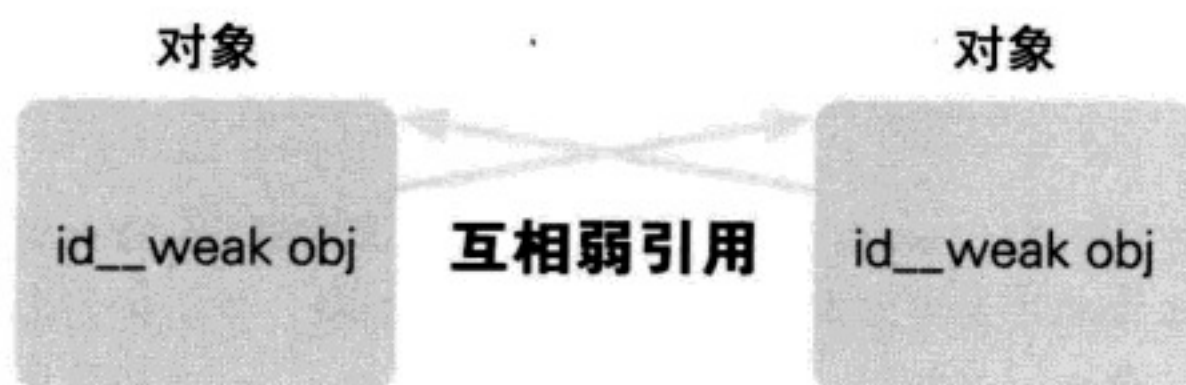
图 1-20 __weak 修饰符避免循环引用
